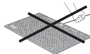
Bevor das Bett verschoben wird, CareMat® entfernen. Somit werden Beschädigungen an der Matte bzw. am Kabel und Steckervermieden.
