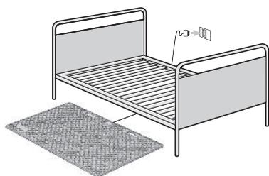
Die CareMat® zentriert vor dem Bett positionieren, damit ein Umgehen der Matte unmöglich ist. Das Kabel unter dem Bett hindurchführen, um die Stolpergefahr zu vermeiden. Stecker in die richtige Steckvorrichtung einstecken.
