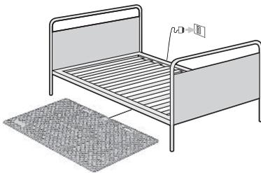
Placera CareMat® i mitten framför sängen så att patienten inte kan gå runt mattan. Lägga kabeln under sängen för att undvika snubbelrisk. Sätt in kontakten i rätt uttag.
