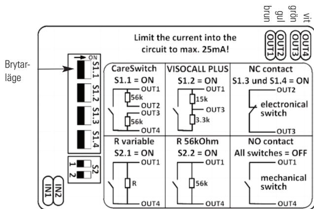
⚠ Efter den elektriska monteringen måste ett funktionstest utföras av installatören.
