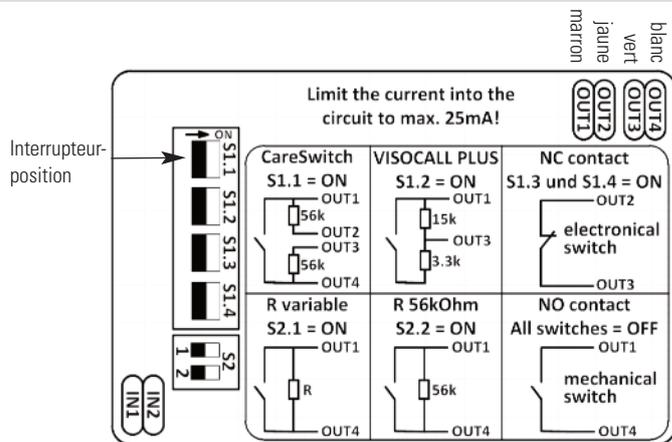
⚠ Après l'installation électrique, un test de fonctionnement doit être effectué par l'installateur
